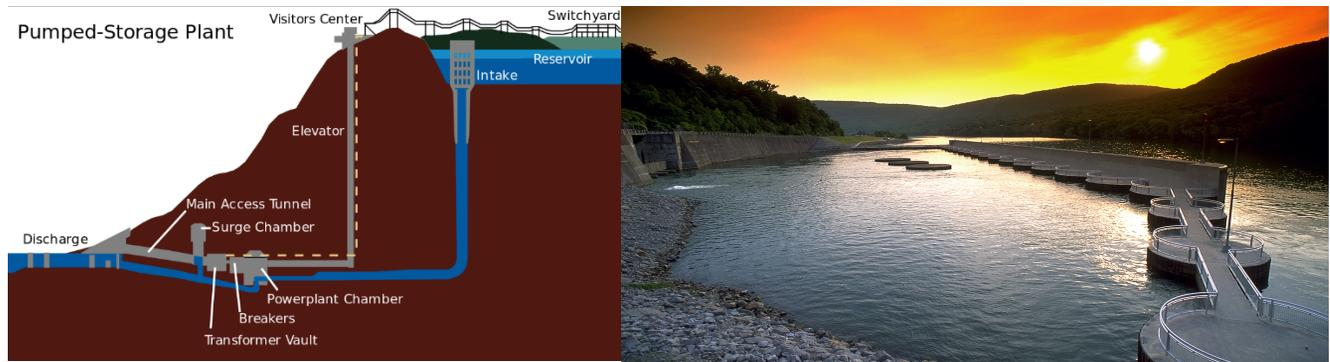
*Figura 4: Diagrama y fotografía de la instalación de almacenamiento por bombeo de TVA en la planta de almacenamiento por bombeo de Raccoon Mountain en Tennessee, Estados Unidos. (Creative Commons Lisense).*
