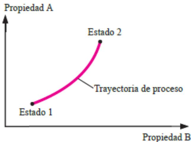
**Figura 2.** Trayectoria de un proceso termodinámico (Çengel & Boles, 2009).
