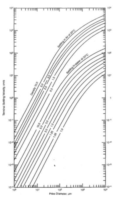
Figura 2. Velocidades, límite de asentamiento para esferas de varios tamaños y densidades en agua y aire (tomado de Aplan, 2003).
